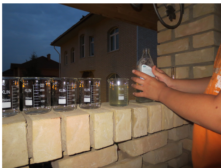
Подготовка растворов загрязнителей. Слева направо: автошампуня, жидкости для разжигания костра и Pepsi-Cola
